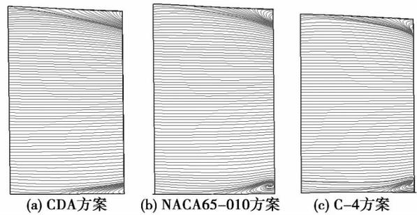
图11 3种方案静叶吸力面极限流线
