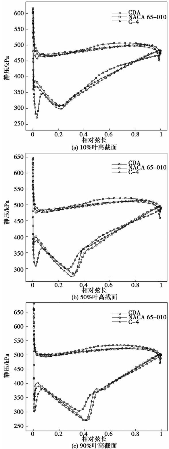
图 8 3 种方案动叶型面压力分布
