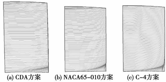
图10 3种方案动叶吸力面极限流线
