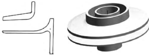
图 8 盖板截面二维草图及三维模型
