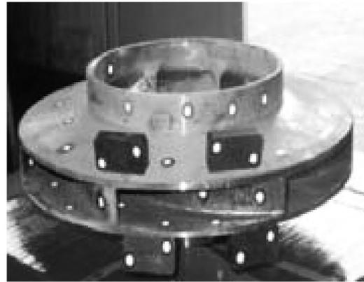
图 3 闭式叶轮盖板
