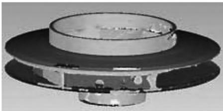
图 6 盖板与油泥模型拼接结果
