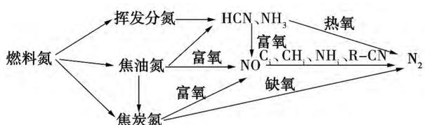
图 2 燃料氮转化的反应路径
