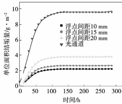
图 7 直径 5 mm 不同间距单位面积结垢量比较
