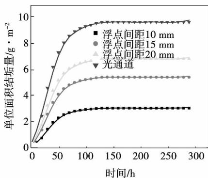
图 6 直径 4 mm 不同间距单位面积结垢量比较
