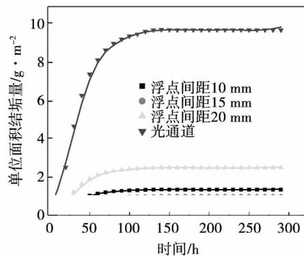
图 8 直径 6 mm 不同间距单位面积结垢量比较
