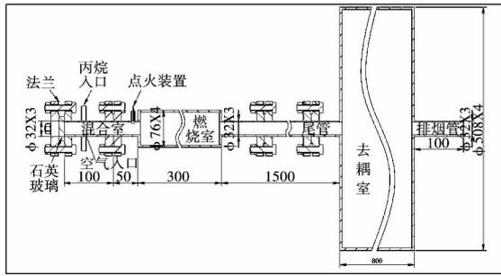
图 1 脉动燃烧器基本结构及尺寸 (mm)
