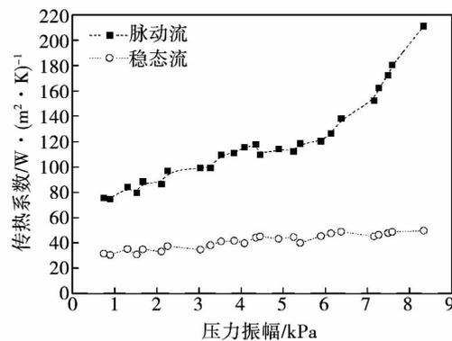
图 3 直尾管传热系数随压力振幅的变化 ( $f \approx 49 \text{ Hz}$ )
