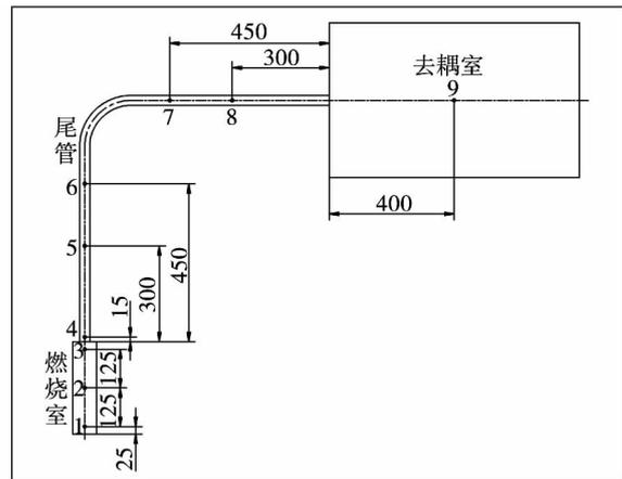
图 2  $90^\circ$  弯尾管脉动燃烧器温度测点布置 (mm)
