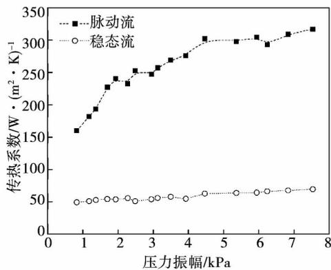
图 4 45°弯尾管传热系数随压力振幅的变化 ( $f \approx 46 \text{ Hz}$ )
