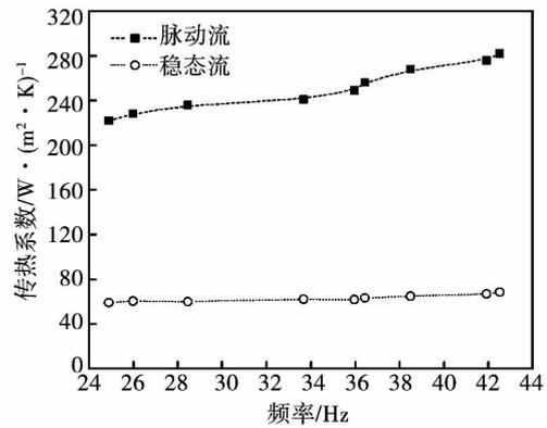
图 10 135°弯尾管传热系数随频率的变化
