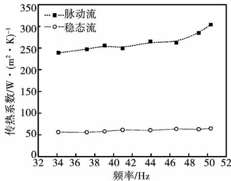
图 8 45°弯尾管传热系数随频率的变化
