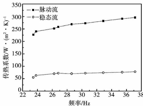
图 9 90°弯尾管传热系数随频率的变化
