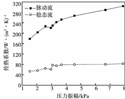
图 6 135°弯尾管传热系数随压力振幅的变化 ( $f \approx 25 \text{ Hz}$ )
