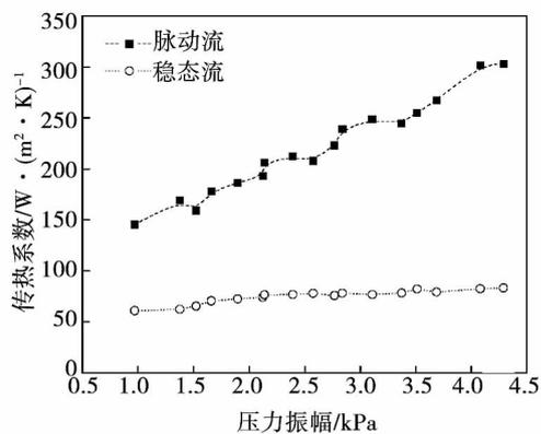
图 5 90°弯尾管传热系数随压力振幅的变化 ( $f \approx 26 \text{ Hz}$ )
