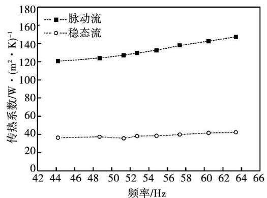
图 7 直尾管传热系数随频率的变化 (压力振幅约为 4 560 Pa)
