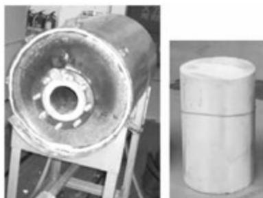
图 4 催化燃烧反应系统及所使用的蜂窝载体
