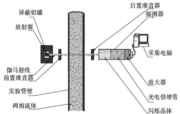
图 3  $\gamma$  射线测量装置原理图
