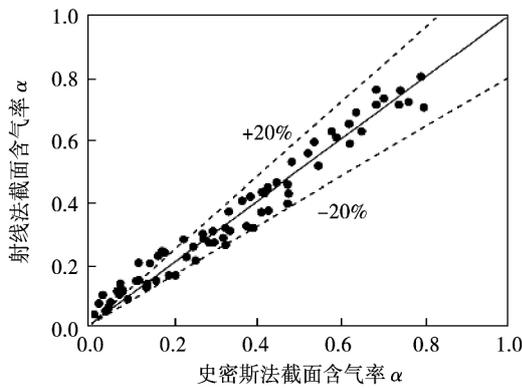
图 11 γ 射线法测量值与史密斯法公式计算值比较
