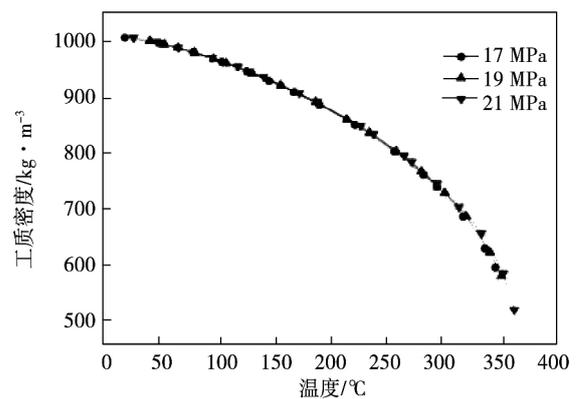
图 7 管内单相水密度随温度变化
