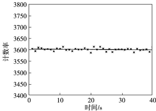
图 5 外界条件无变化时计数率概率性波动
