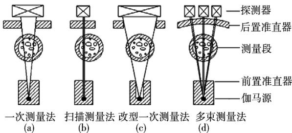
图 1 伽马射线法测截面含气率多种方法比较
