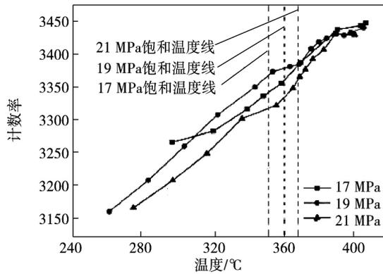
图 8 饱和温度前后计数率随工质温度变化
