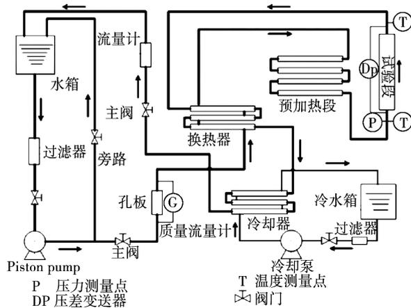
图 2 高温高压汽-水两相流实验系统
