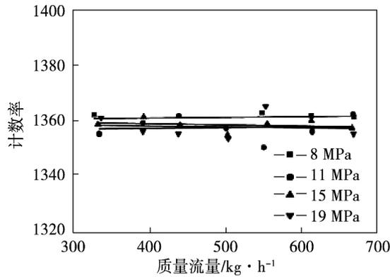
图 4 20 °C 时不同压力下计数率随质量流量的变化
