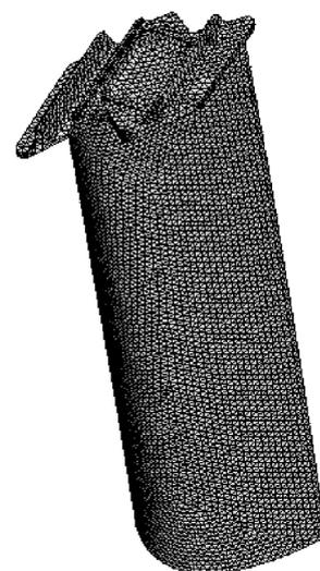
图 5 带冠叶片有限元网格图
