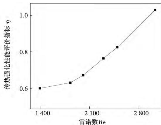
图 10 管内加装波形板扰流件时的传热强化性能评价指标 η 和雷诺数 Re 的变化关系
