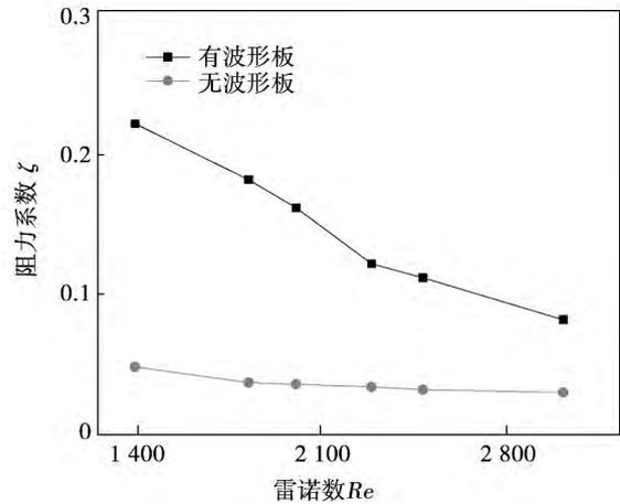
图 9 管内有、无波形板扰流件时的阻力系数 ζ 和雷诺数 Re 的变化关系
