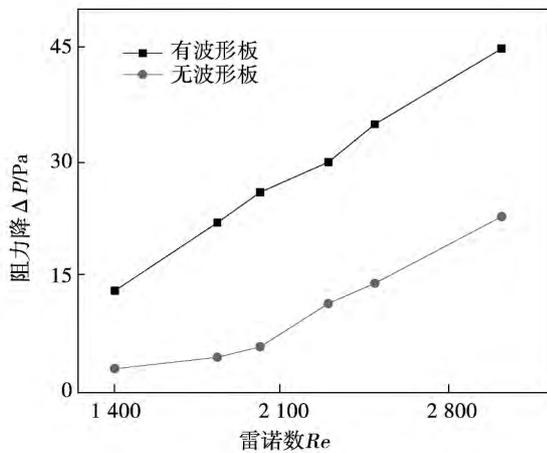
图 8 管内有、无波形板扰流件时的阻力降 ΔP 和雷诺数 Re 的变化关系
