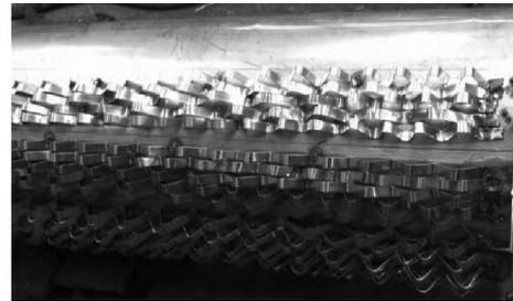
图 3 制造中的波形板扰流件
