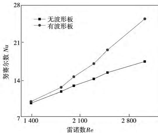
图5 管内有、无波形板扰流件时的气体对流传热性能比较
