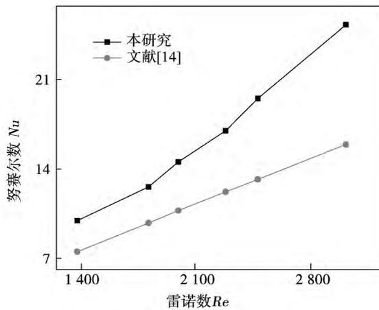
图 7 加装波形板扰流件后的管内气体传热性能比较
