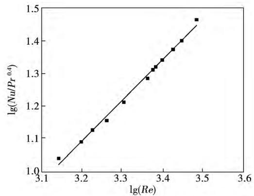
图 4 管内加装波形板扰流件后的气体努赛尔数  $Nu$  - 雷诺数  $Re$  数据汇总
