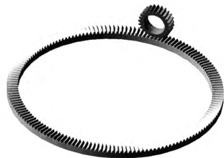
图 5 基于 Adams 的面齿轮副动力学模型
