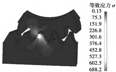
图 10 面齿轮副的等效应力
