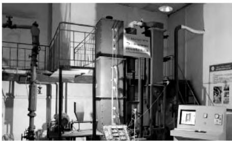
图 1 流化床燃烧试验系统
