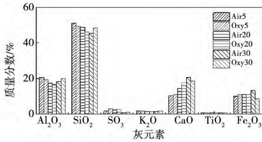
图 5 不同工况下主要元素 XRF 测试结果
