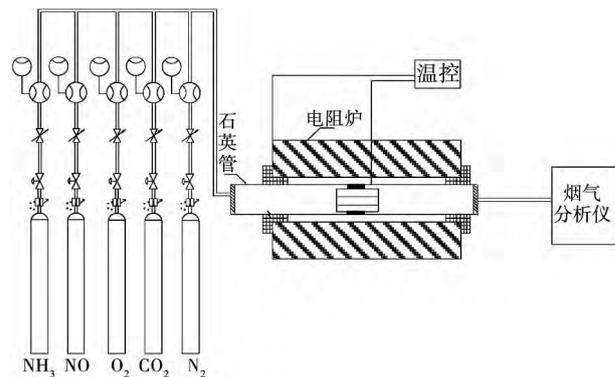
图1 管式炉
