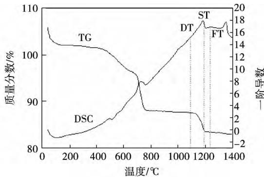
图 2 神华煤低温灰 TG/DSC 热分析曲线图
