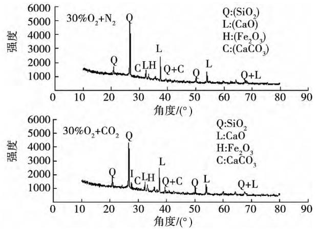
图 4 30% O<sub>2</sub>/N<sub>2</sub>与 30% O<sub>2</sub>/CO<sub>2</sub>对比图
