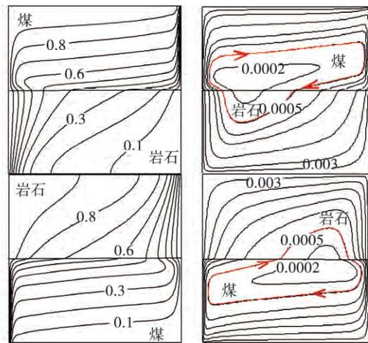
图 6 无量纲温度(左)、流线分布图(右)
