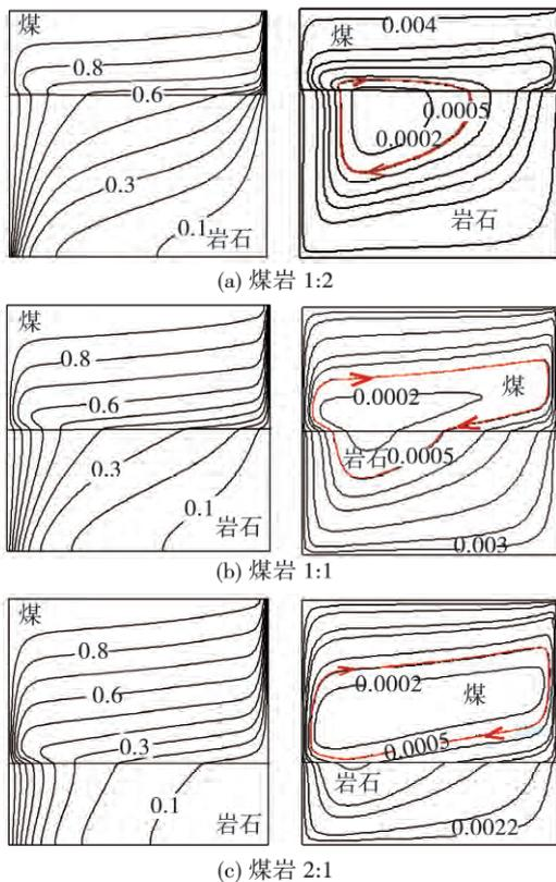
图 4 无量纲温度(左)、流线分布图(右)
