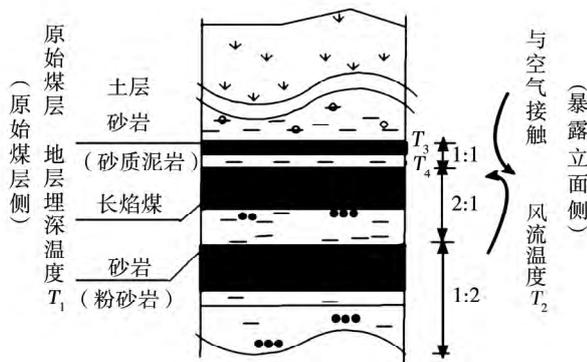
图 1 煤层构成简图
