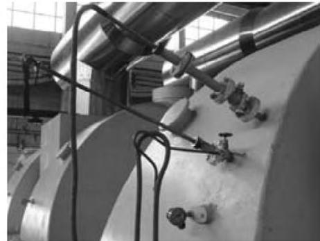
图 1 微波谐振法测量排汽湿度
