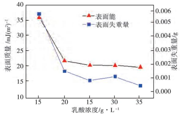
图 11 试样表面能和失重量随乳酸浓度的变化
