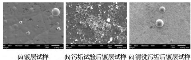
图 8 镀层表面微生物污垢实验前后微观形貌
