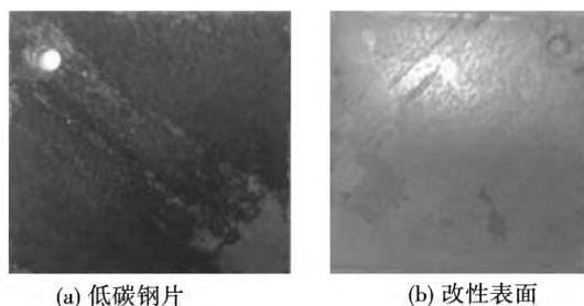
图 7 微生物污垢实验后改性表面试样和碳钢试样宏观形貌对比
