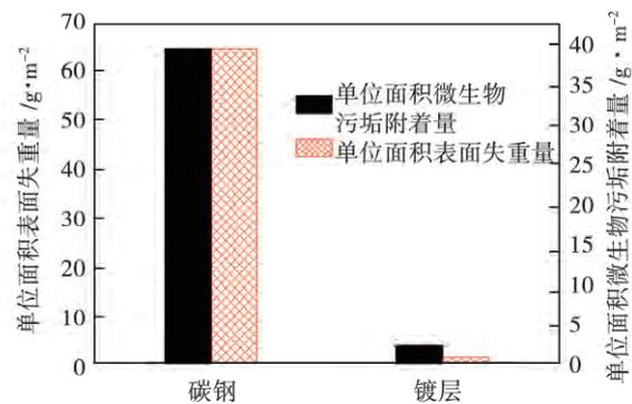
图 12 镀层和碳钢试样表面失重量和微生物污垢附着量对照
