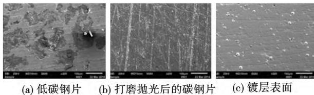
图 6 试样表面微观形貌
