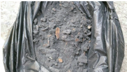
图 3 130 t/h 锅炉新增低温受热面入口灰样
