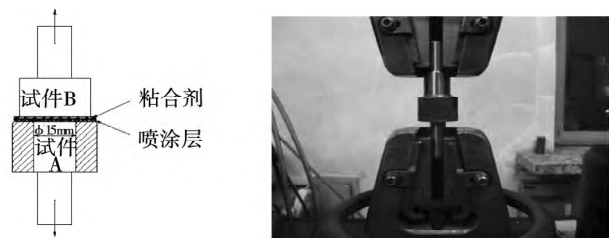
图 5 拉伸试件的示意图和实物图
