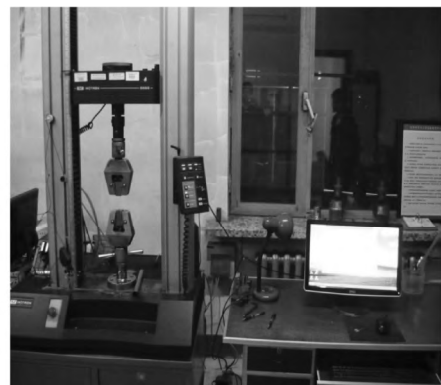
图 4 INSTRON5569 万能拉伸试验机
