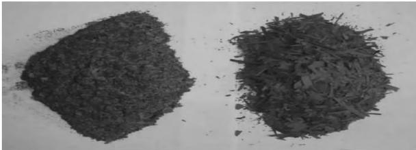
图 3 剥落氧化皮形貌
