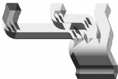
图3 除尘器前烟道优化方案1几何模型
