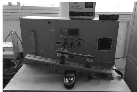
图 4 热管传热性能测试台
