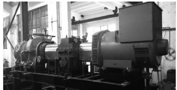
图3 螺杆膨胀发电机组试验台
