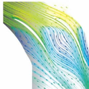
(b) 设置微小圆柱轴流风机叶高80%截面处流线图
