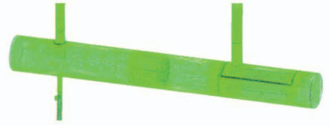
图4 分离器模型的网格离散化
