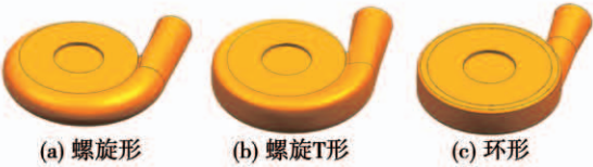
图 5 3 种压水室结构示意图
