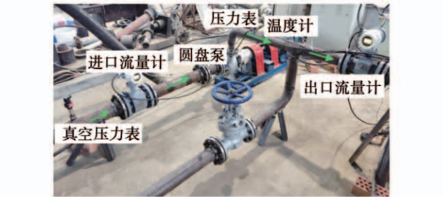
图 3 实验设备台 Fig. 3 Experimental equipment platform
