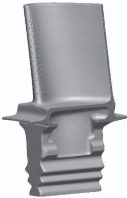
图 1 涡轮一级动叶外形 3D 扫描结果
