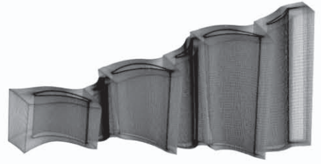
图6 全新涡轮结构化网格
