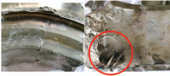
图 12 轮盘破裂后盘心部位放大图
