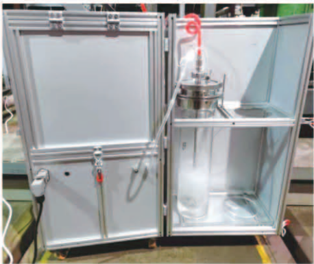
图 4 负压采样系统安装图
