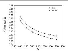
图 6 不同结构微通道平均摩擦系数随雷诺数变化
