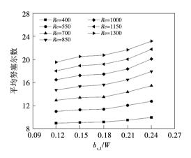
图 10  $b_{s,1}/W$  对微通道平均努塞尔数的影响 Fig. 10 Effect of  $b_{s,1}/W$  on average Nusselt number of microchannels
