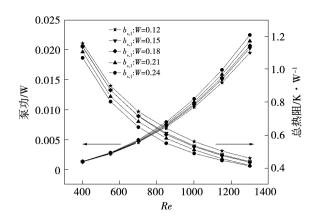
图 12  $b_{s,1}/W$  对总热阻和泵功的影响 Fig. 12 Effect of  $b_{s,1}/W$  on total thermal resistance and pumping power
