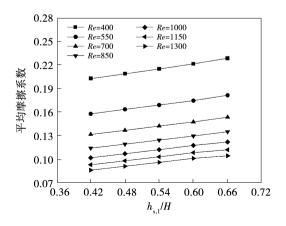
图 13  $h_{s,1}/H$  对微通道平均摩擦系数的影响 Fig. 13 Effect of  $h_{s,1}/H$  on average friction coefficient of microchannels
