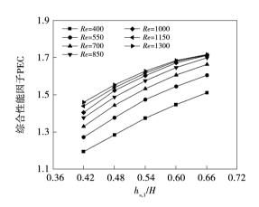
图 15  $h_{s,1}/H$  对微通道综合性能因子的影响 Fig. 15 Effect of  $h_{s,1}/H$  on comprehensive performance factor of microchannels
