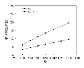
图 5 不同结构微通道平均努塞尔数随雷诺数变化
