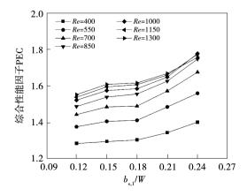
图 11  $b_{s,1}/W$  对微通道综合性能因子的影响 Fig. 11 Effect of  $b_{s,1}/W$  on comprehensive performance factor of microchannels
