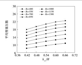
图 14  $h_{s,1}/H$  对微通道平均努塞尔数的影响 Fig. 14 Effect of  $h_{s,1}/H$  on average Nusselt number of microchannels
