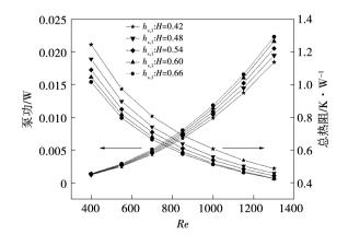
图 16  $h_{s,1}/H$  对总热阻和泵功的影响 Fig. 16 Effect of  $h_{s,1}/H$  on total thermal resistance and pumping power
