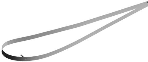
图 5 带单个冷却孔的叶片模型
