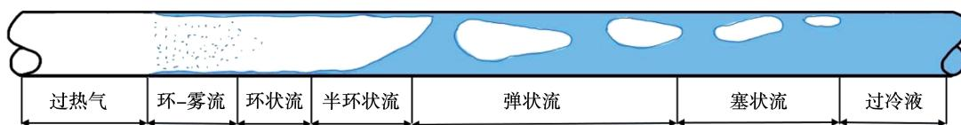
图 4 冷凝过程中的流型变化
